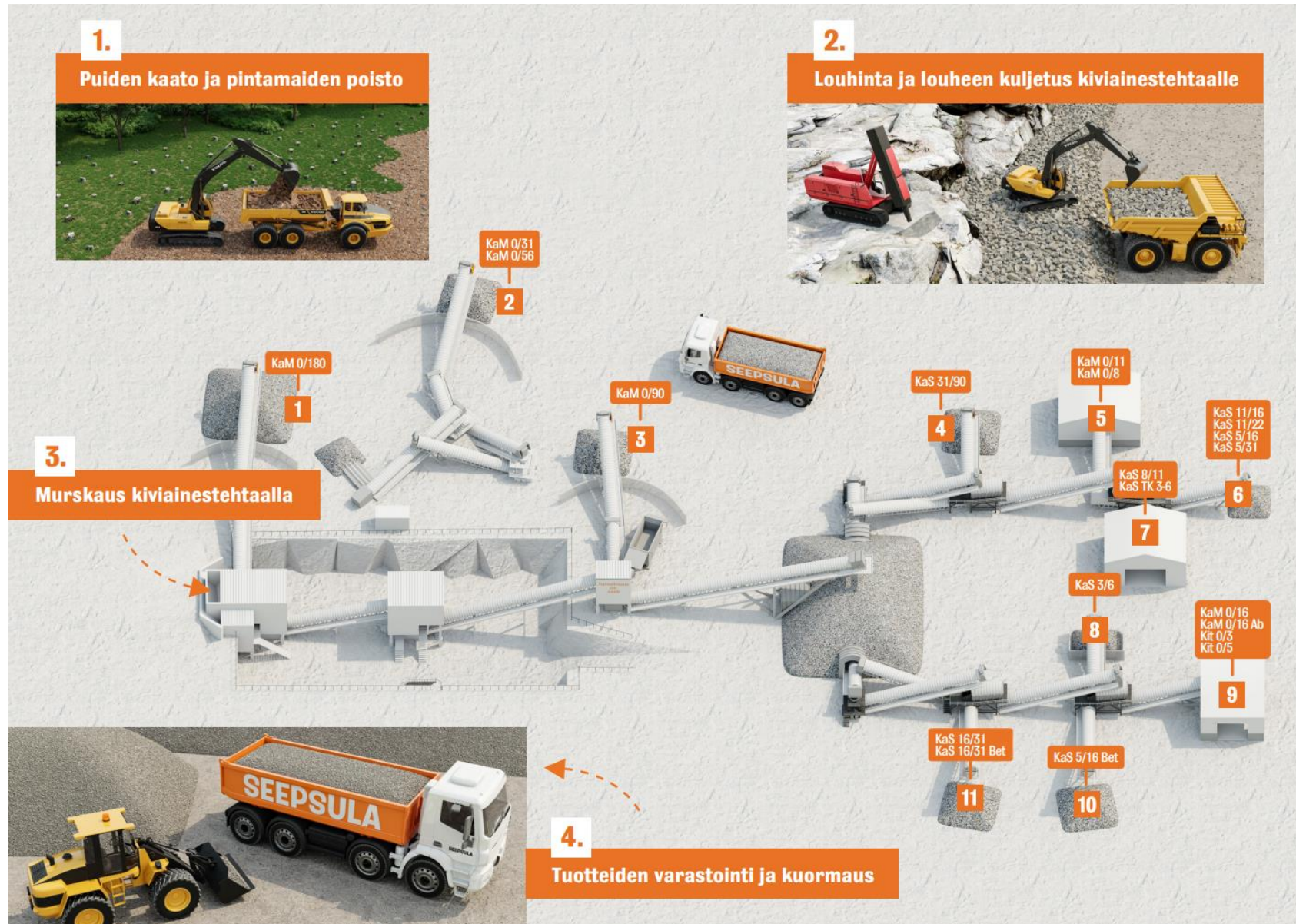
Kuva 1. Kiviainest tuotteiden tuotantoprosessi.
