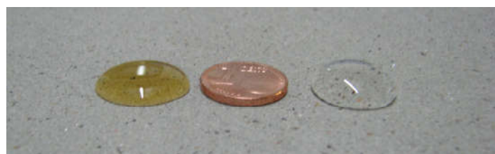
Suojattu COLORTEC® Maxilla , vasemmalla öljyä, oikealla vettä.
