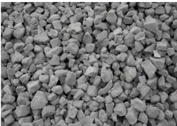
Kuva 4.1. Foamit® -vaahtolasimurskeen tyypillinen raemuoto.
