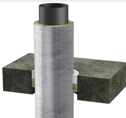
Figur 9. GPG:n paksuus 50 mm. Läpimenevä putkieriste 30 mm paksu, jatkuu 550 mm laatan kummallakin puolella
