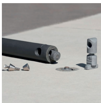
Pollarin liitoskappale on katkennut. Liitoskappaleen vaihto kestää muu- taman minuutin.
