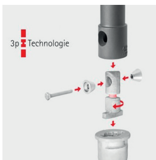
3p-Tech osat: pollari, maa-ankkuri, liitoskappale ja kiinnityksetti
