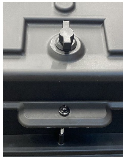
Kuva 8. Kattoluukun lukitus ja ruuvi varmistus
