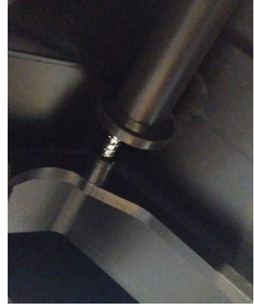
Kuva 7. Ruuvi paikoitettu oikein
