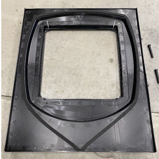
Kuva 3. Saumanauhan kiinnitys pohjaosaan
