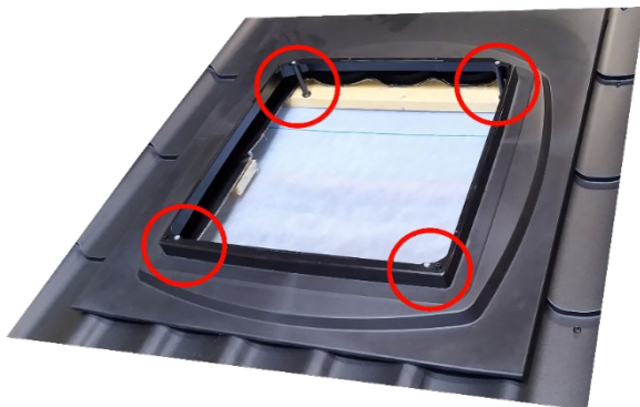
Kuva 4. Pohjaosan kiinnitys ruoteisiin, holkkien läpi ruuvatuilla ruuveilla.
