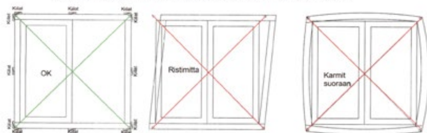
Riittävä määrä kiiloja, 500mm välein min. Karmi oltava ristimitassa Karmi puut suorassa
