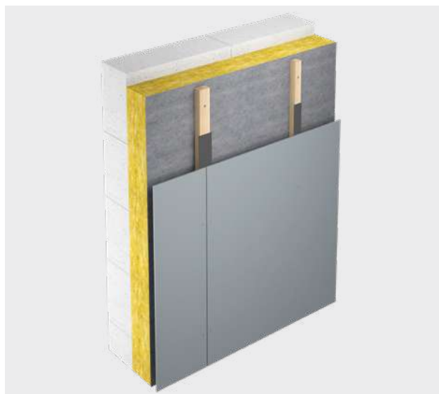
Koolaus kiinnitettynä runkoankureilla alustaan
