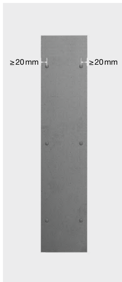
Lvyjen väärä asennustapa ikkuna- ja ovialueelle sekä muissa aukotuksissa.
