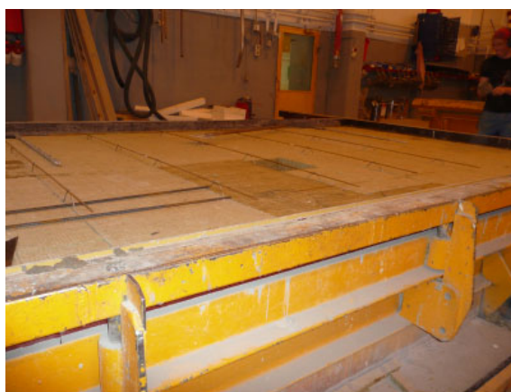
Kuva 23. Diagonaaliansaiden ankkurointi sisäkuoreen.
