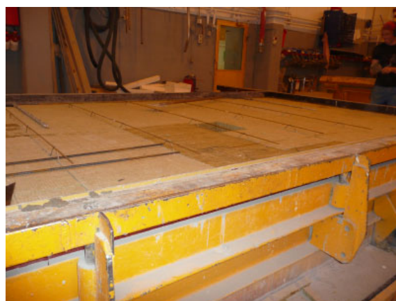
Kuva 23. Diagonaaliansaiden ankkurointi sisäkuoreen.
