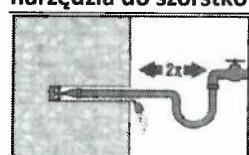
Przepłykać dwukrotnie wywiercony otwór poprzez wprowadzenie aż do dna otworu węza z wodą (ciśnienie z instalacji wodociągowej) i płukanie do momentu, gdy woda wypływająca z otworu będzie czysta.
