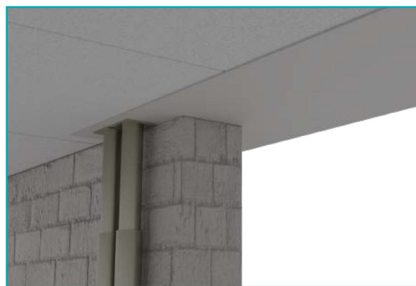
Palkin pään tuenta seinän päässä
