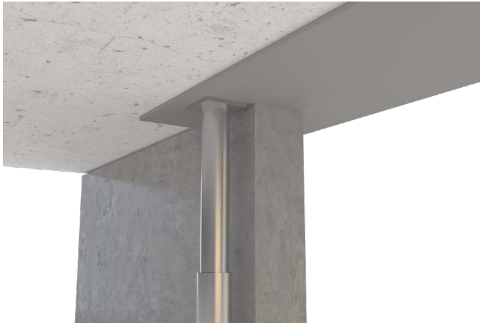
Kuva 7. DELTABEAM®-liittopalkin tuenta, kun palkki asennetaan seinän päädyn varaan.
