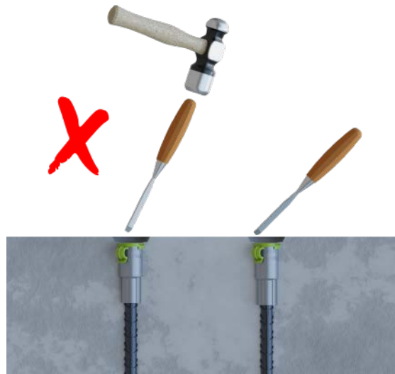
Kuva 13. JENKA-nostoankkureiden muokkaaminen on kielletty.
