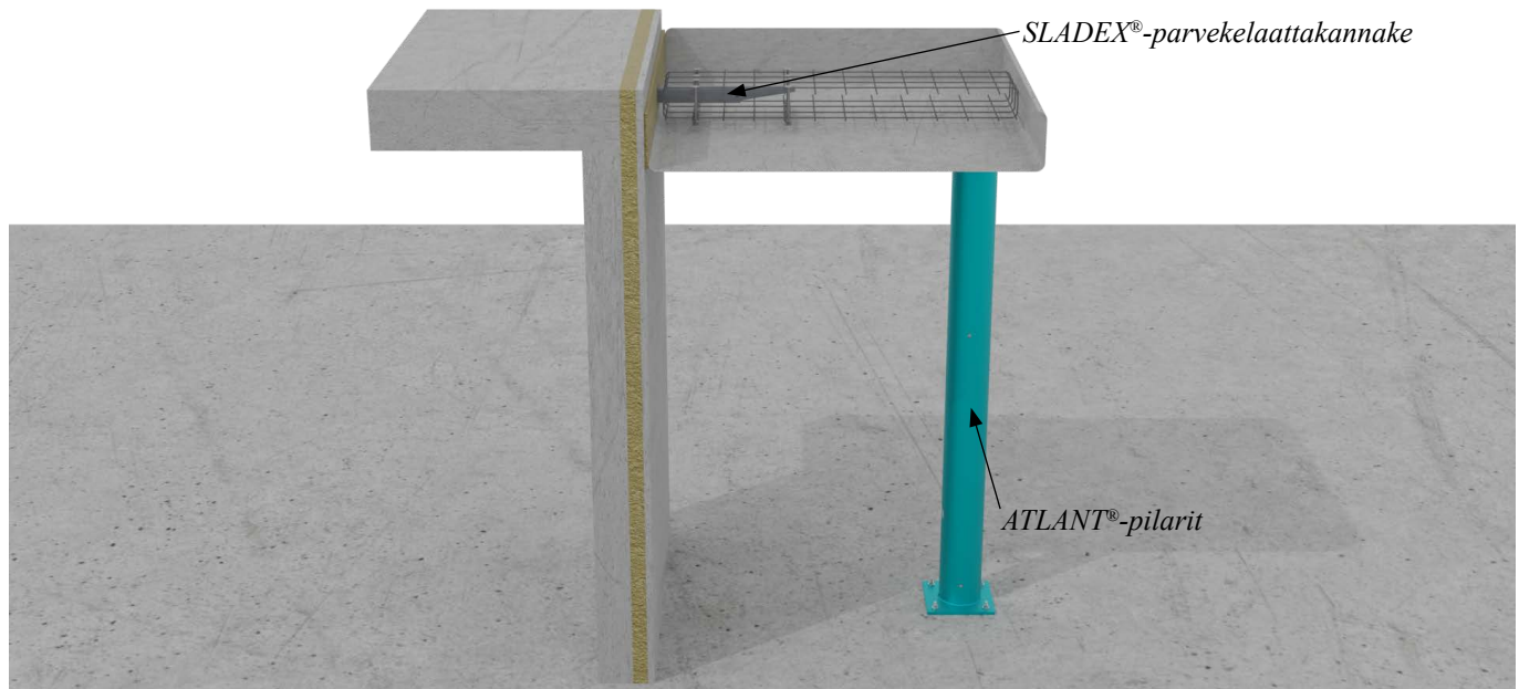
Kuva 8. Esimerkki: SLADEX®-parvekelaattakannakkeilla ja ATLANT®-liittopilareilla tuetut parvekelaatat.
