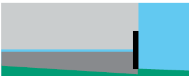
Yläkuva: Hyvin usein betonivaluissa valu jää hieman vajaaksi muotin pinnasta.
