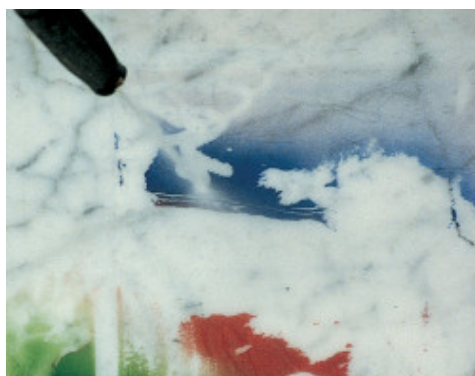
WallGard Graffiti Barrierilla käsiteltyä Carraran marmorilla päällystettyä pintaa pestään painepesurilla
