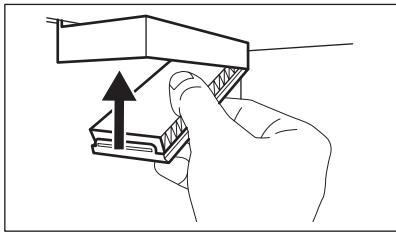
Sostituire il filtro dell'aria ogni 6 mesi.
