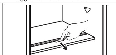
Per rimuovere il dispositivo di controllo dell'umidità, aprire il cassetto sotto il ripiano in vetro ed estrarre il coperchio.
