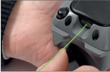
25. Poista kuidun vetorasitus kääntämällä kahvaa 180 astetta.
