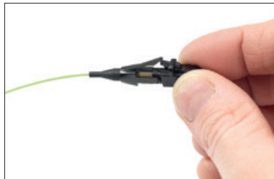
29. Kiinnitä liittinpidike ja taivutussuoja.
