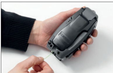
22. Työnnä katkaistu ja valmisteltu kuitu työkaluun kiinnitettyyn kuituliittimeen.
