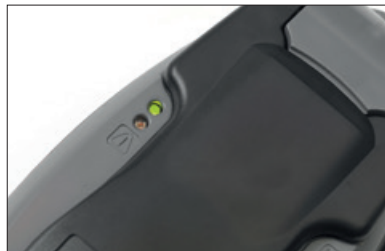
8. Sulje ja lukitse työkalun kansi, tarkista että vihreä lamppu palaa. Jos lamppu ei pala, avaa kansi ja sijoita kuituliitin oikein.
