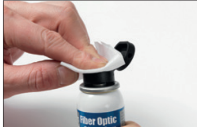
14. Laita yksi painallus puhdistusnestettä nukkaamattomaan liinaan.
