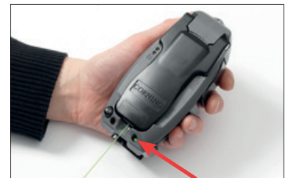
24. Vihreän lampun palaminen osoittaa, että kytkeminen on suoritettu oikein.
