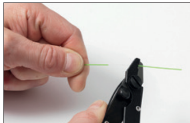
11. Kuori ulkoeristettä vähintään 40 mm. Käytä kuorintapihtien ulko-osaa.
