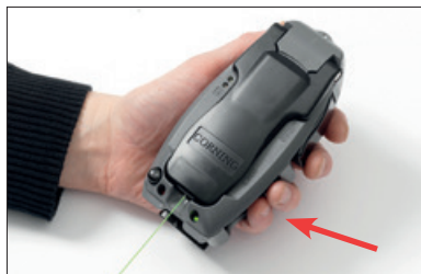
23. Kun kuitu on työnnetty kokonaan kuituliittimeen, se lukitaan painamalla työkalun alinta painiketta.
