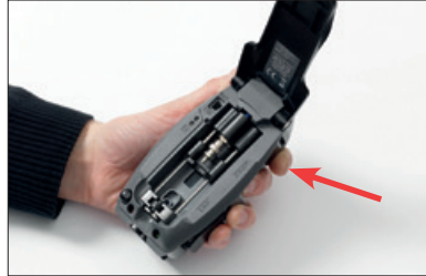
2. Valmistele työkalu: avaa kansi, paina oikeassa ylänurkassa sivupainiketta, jolloin kelkka nousee ylös.
