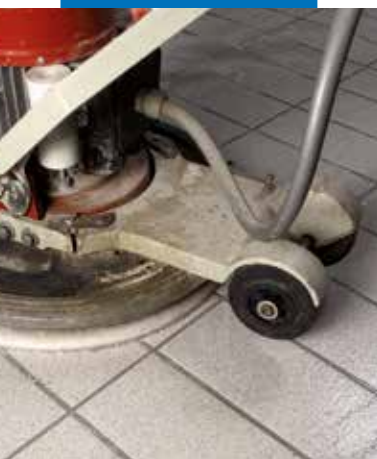
Laatoituksen pesu vedellä ja Scotch-Brite®-laikalla varustetulla lattianhoitokoneella
