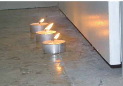
Esimerkiksi kynttilöiden avulla voidaan paikallistaa ilmavuotokohdat.
