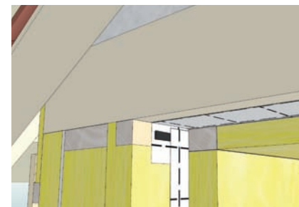
Yläpohja: Tuulettuva yläpohja
