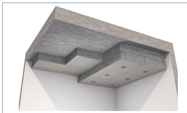
Kaksinkertainen levyasennus (2x175) mm.
