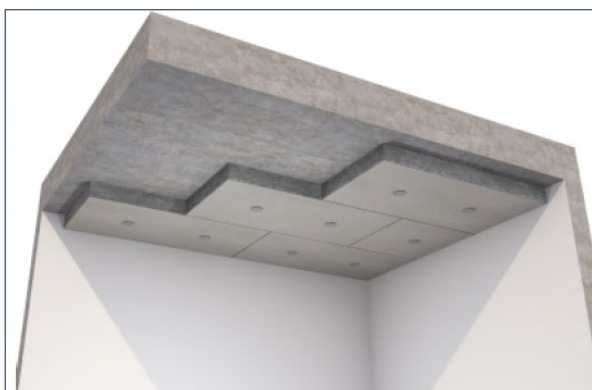
Yksinkertainen levyasennus (50/100/175) mm.
